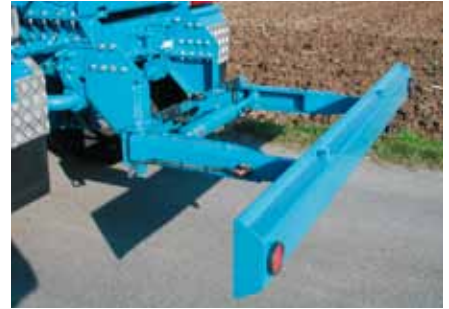
Unterfahrerschutz in vielen Varianten: mechanisch, hydraulisch oder pneumatisch
