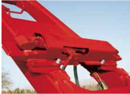
Doppelt wirkende hydraulische Behälter- verriegelung.
