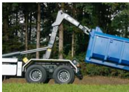
Mehr Hebekraft dank tief liegendem Drehpunkt des Knickarms.
