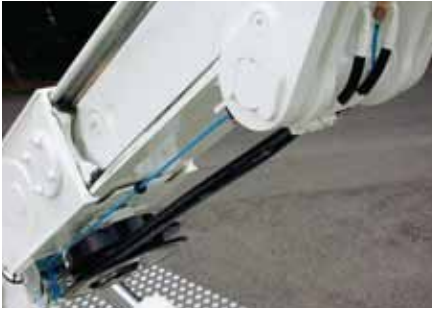
Wartungsfreundliche Schwalbenschwanz- Führung des Haupt-/Teleskoparms.
