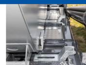
Barre anti-encastrement arrière à déploiement pneumatique
