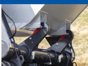
FIX-Point – sécurité latérale hydraulique des bennes
