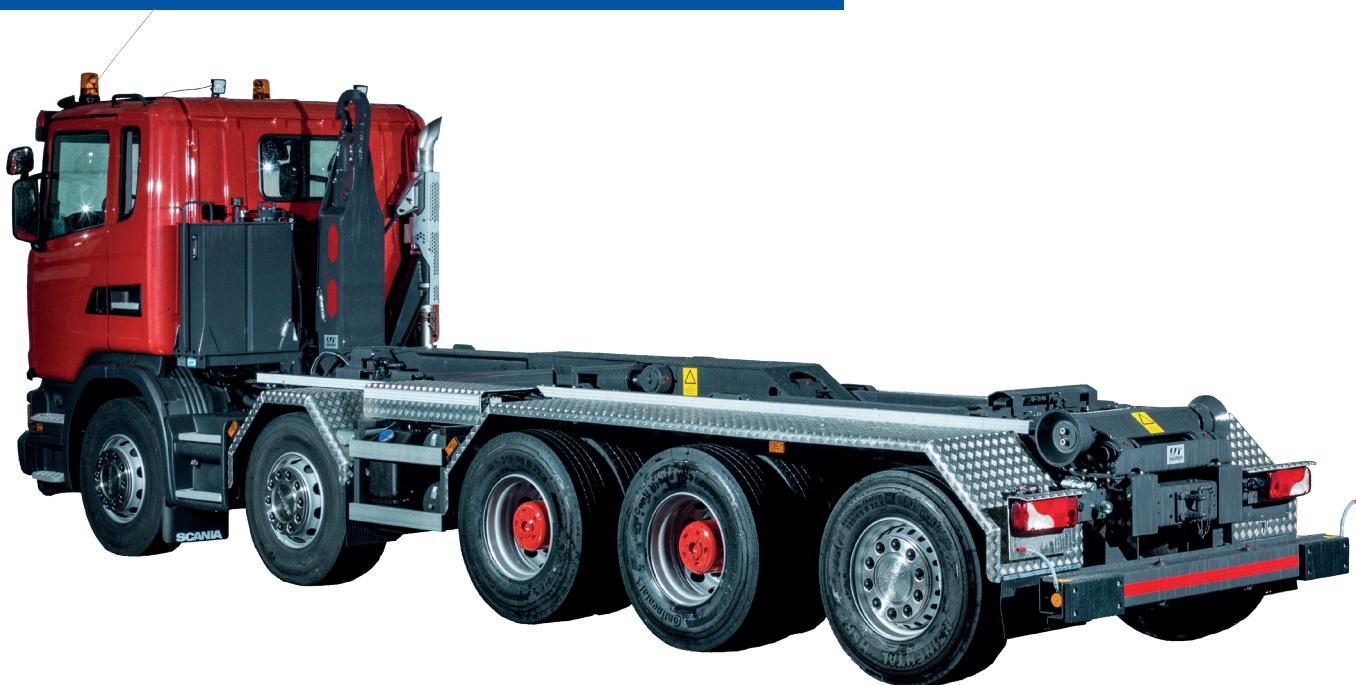
**Von der Konstruktion über die Produktion bis zur Montage: Der Abrollkipper SAURIER wird auf Ihre Bedürfnisse abgestimmt. Dank der ausgewogenen Geometrie, der optimalen Gewichtsverteilung und der robusten Bauweise machen unsere Abrollkipper den Arbeitsalltag auf sichere Weise effizient.**
